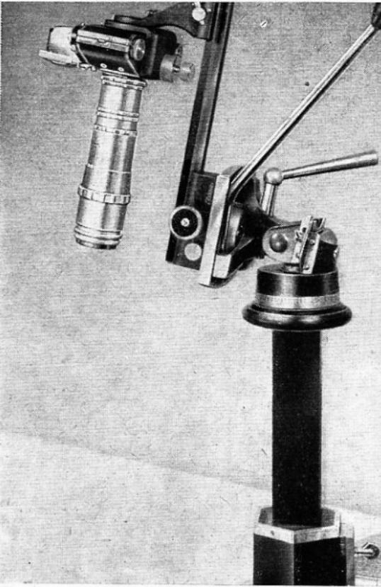
Obr. 21: Otáčecí úhlový přístroj na stativu: svislá pracovní poloha
