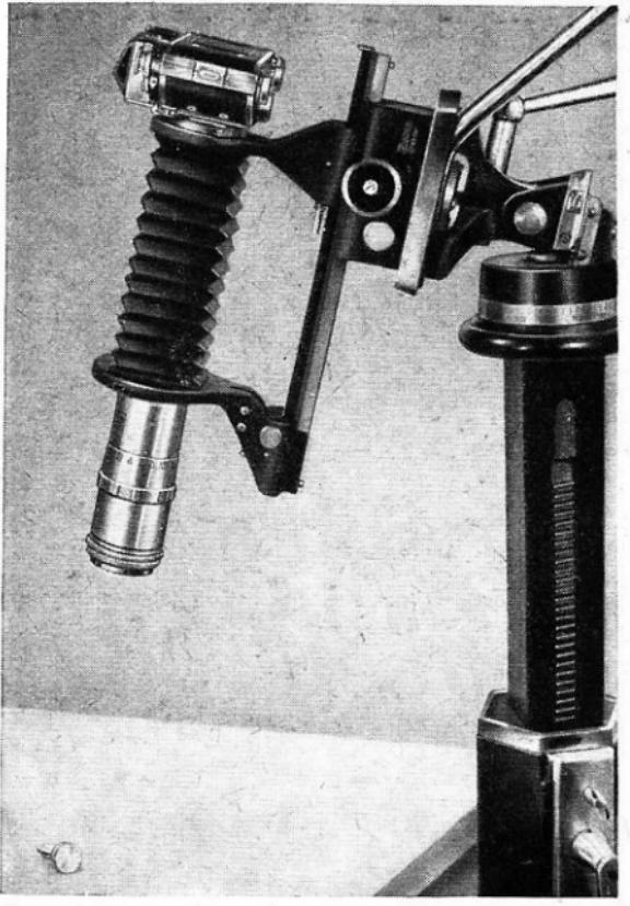
Obr. 20: Měchový zaostřovací přístroj na stativu: svislá pracovní poloha
