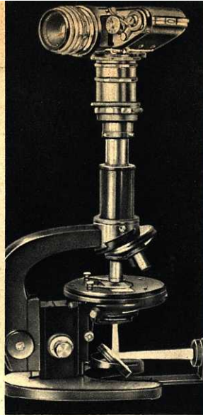
De objectiefzoeker in de microfotografie.
