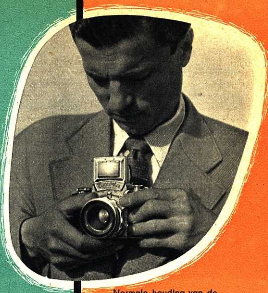
Normale houding van de EXAKTA Varex met lichtkapzoeker op borst- of schouderhoogte.
