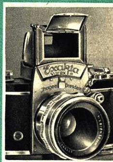
De lichtkapzoeker als raamzoeker, voor het rechtstreeks waarnemen van het object.
