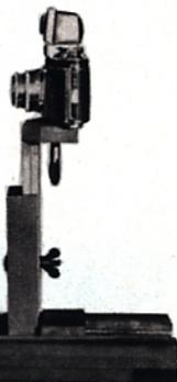
**La rallonge du dispositif de reproduction** se visse à l'extrémité inférieure de la console; elle donne à l'ensemble du dispositif la hauteur nécessaire pour permettre également la mise au point avec l'hélicoïde seule, sans lentille additionnelle ni tubes de rallonge. L'hélicoïde réglée sur la plus courte distance, c'est-à-dire complètement sortie, on reproduit une image de 30x45 cm. sur négatif 24x36 mm. Prix de la rallonge: consulter le tarif à la fin de cet imprimé.
