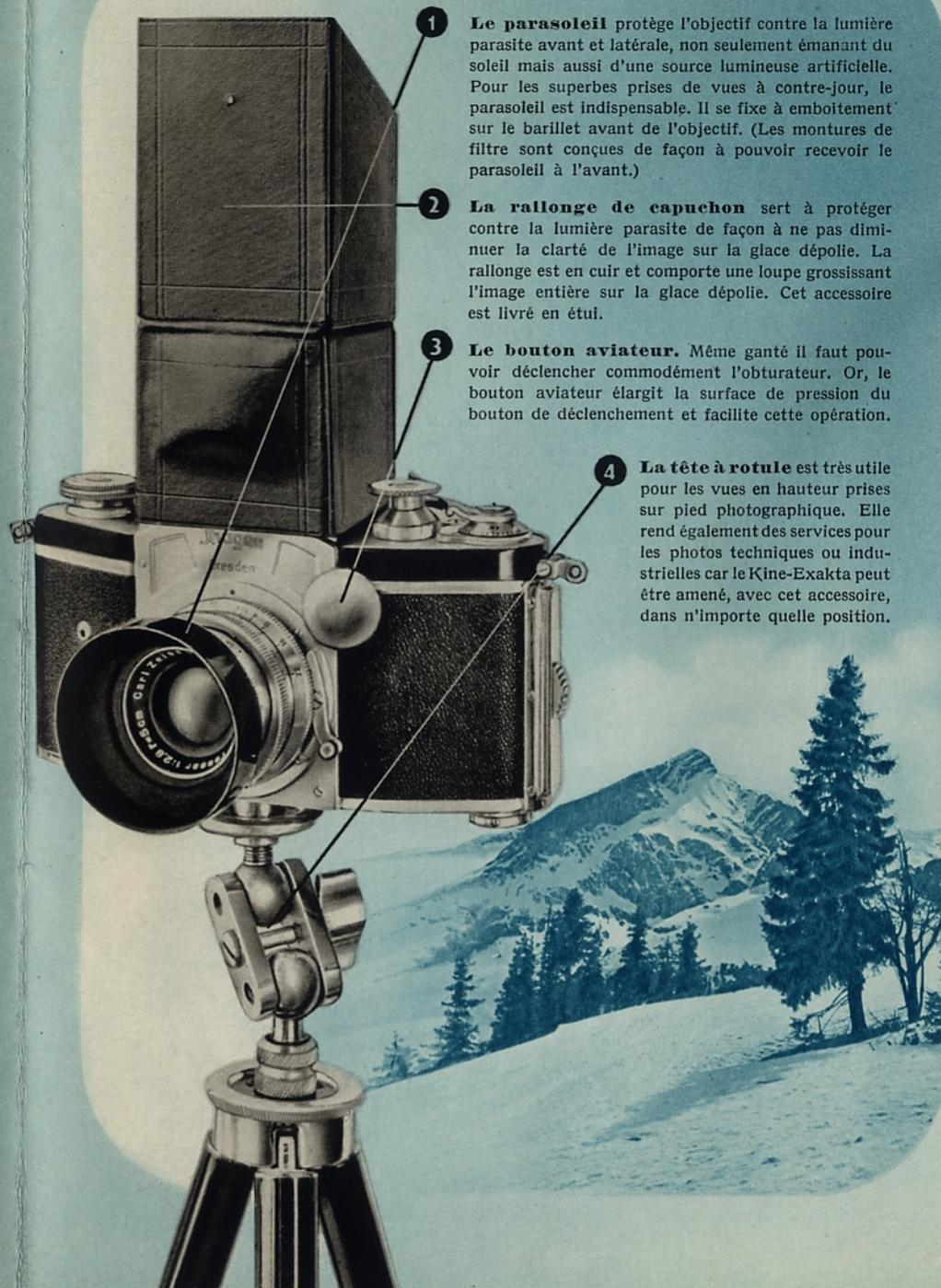
**1 Le parasoleil** protège l'objectif contre la lumière parasite avant et latérale, non seulement émanant du soleil mais aussi d'une source lumineuse artificielle. Pour les superbes prises de vues à contre-jour, le parasoleil est indispensable. Il se fixe à emboîtement sur le barillet avant de l'objectif. (Les montures de filtre sont conçues de façon à pouvoir recevoir le parasoleil à l'avant.)
