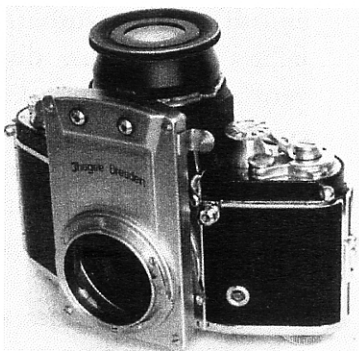
Mesure-pose Ihagee monté sur un Exakta VX muni d'un bloc d'ampli-visée et d'une loupe de
