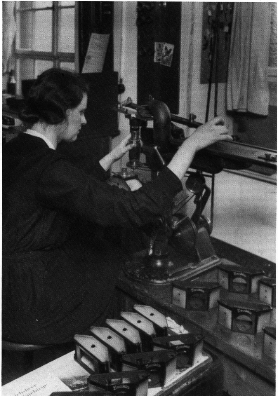
Het graveren van de naam Exakta. Daarbij wordt gebruik gemaakt van een apparaat dat de tekst verkleind overneemt van een zeer grote plaat.
