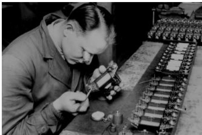
Montage de l'Exakta VP
