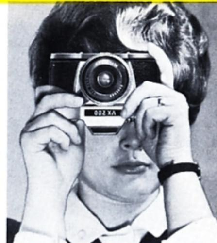
Für normale Hoch- und Queraufnahmen VX 200 am besten in die rechte Hand nehmen und mit rechtem Daumen und Zeigefinger scharf einstellen. Mit der linken Hand Kamera zusätzlich halten und mit dem linken Zeigefinger auslösen. – Sehbehinderte stellen im Prismensucher mit der für Fernbetrachtung nötigen Brille ein.
