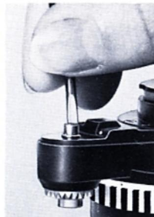
Zum Überprüfen der Schärfentiefe bei Einstellversuchen Auslöseknopf (3) nur so weit hineindrücken, daß wie gewünscht abgeblendet, der Verschuß aber noch nicht ausgelöst wird. – Damit der Verschußauslöseknopf (17) stets bis zum Auslösen des Verschlusses hineingedrückt werden kann, ist die Stellschraube der Auslöseeinrichtung des Objektivs mit einem Schraubenzieher auf die nötige Länge einzustellen. – In den Auslöseknopf (3) kann ein Drahtauslöser mit langem Druckstift eingeschraubt werden.
