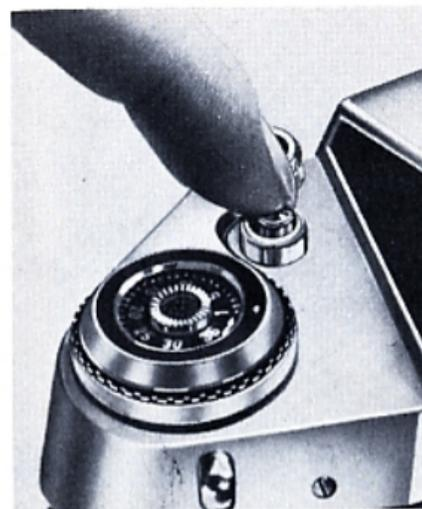
1. Rückspulauflöser (10) in seine Fassung hineindrücken. Er wird arretiert, federt aber beim nächsten Verschlussspannen zurück.
