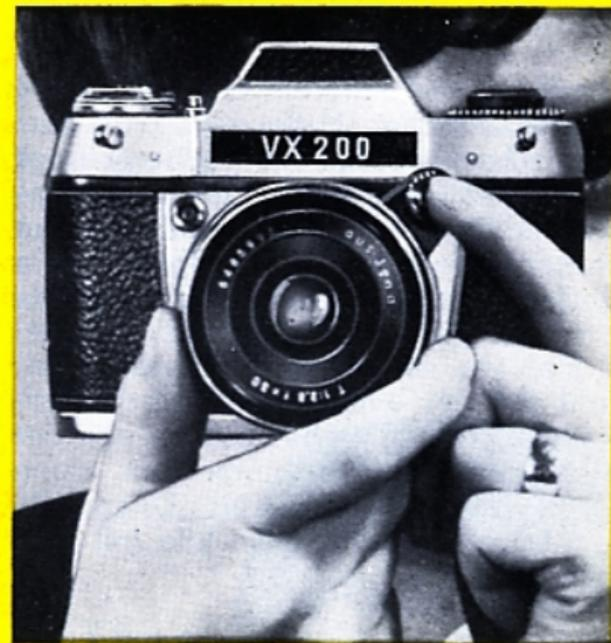
2. Scharfeinstellen durch Drehen am Entfernungseinstellring (5) und durch Kontrollieren der Schärfe des Reflexbildes im Prismensucher (12).
