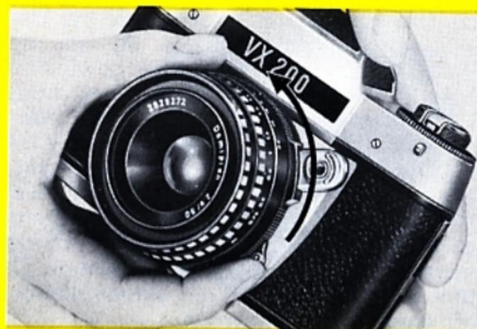
3. Objektiv (1) auswechseln: Arretierhebel (18) zum Objektiv hin drücken. Objektiv nach links drehen, bis sich die roten Punkte (2 und 7) gegenüberstellen. Objektiv nach vorn abnehmen. – Beim Einsetzen umgekehrt verfahren: Rote Punkte gegenüberstellen, Objektiv bis zum Einrasten nach rechts drehen. – Spezialobjektive von den kürzesten bis zu den längsten Brennweiten verwendbar.
