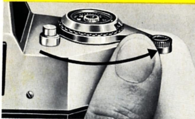
1. Verschlussspannen und Filmtransport mit dem Spannhebel (11). Diesen Hebel nach dem Auslösen stets in einem Zuge bis zum festen Anschlag schwenken und zurückgehen lassen.
