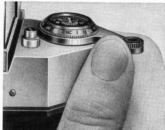
été prise. Le déclenchement ne peut se faire lorsque l'obturateur n'est pas complètement armé et, par conséquent lorsque la vue précédente n'est pas escamotée, donc, s'il y a résistance, ne pas forcer, vérifier.
