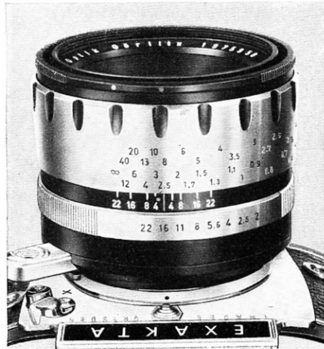
Objektivöffnung durch Drehen des Blenden-einstellrings dicht vor dem Kameragehäuse. Die Blende bleibt entsprechend der Drehung des Ringes geschlossen (notwendig für längere Belichtungszeiten und Selbstauslöseraufnahmen). Der Blendeneinstellring rastet bei allen Werten ein, auch bei den nicht gravierten Zwischenwerten zwischen zwei Zahlen. Der gewünschte Wert muß dem roten Markierungsstrich gegenüberstehen.
