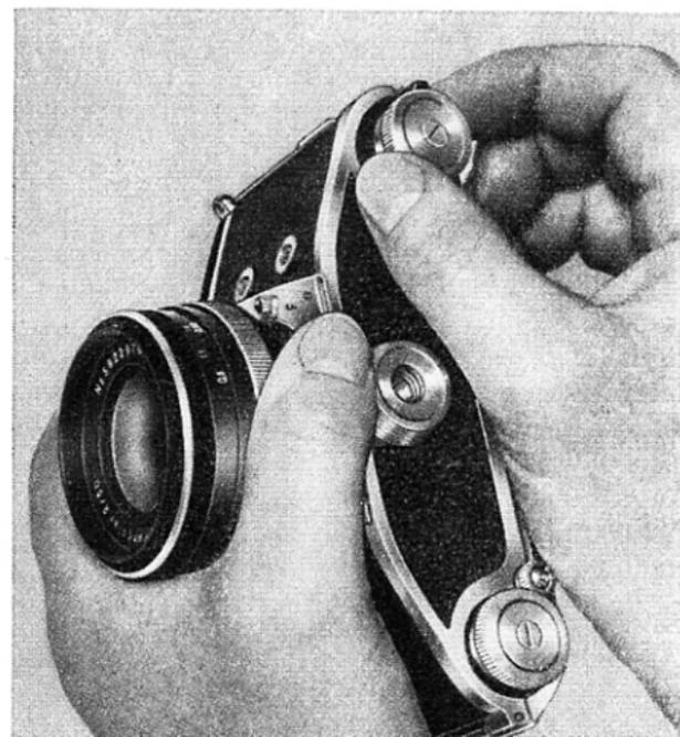
pen. - Beim Schließen Rückwand (44) leicht andrücken. Drehknopf (1) nach links oder rechts drehen, bis er in die ursprüngliche Stellung zurückspringt. - Soll die Rückwand (44) von der Kamera gelöst werden, dann bei geöffneter Rückwand Scharnierstift am Knopf (21) herausziehen. Beim Wiederbefestigen Rückwand an die Kamera anhalten und Scharnierstift in das Scharnier einführen.
