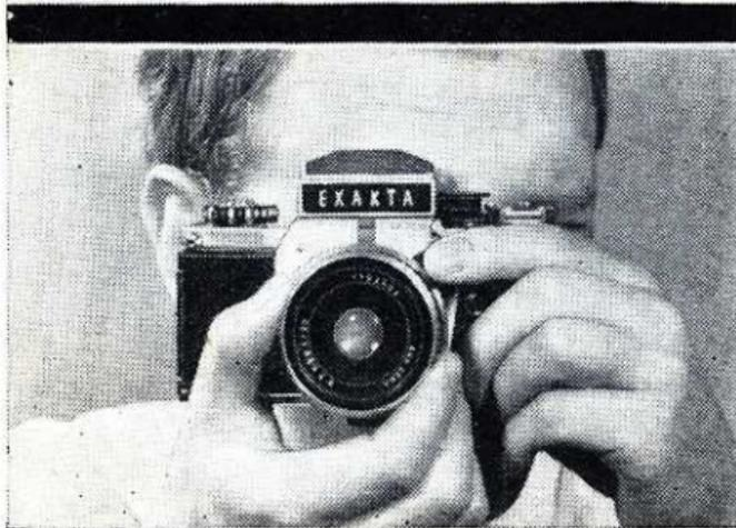
Zum Scharfeinstellen nach dem Reflexbild große Objektivöffnung, also kleinste Blendenzahl, anwenden (helles Bild), und erst kurz vor dem Belichten abblenden. Nicht erforderlich ist, dafür die Kamera aus der Aufnahmehaltung abzusetzen, weil die Objektiv mit vollautomatischer Druck- oder Springblende versehen sind. Näheres siehe Objektivbeschreibungen ab Seite 26.
