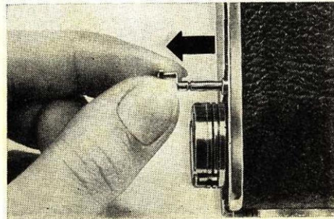
Wird eine leere Filmpatrone zum Aufwickeln des Films benützt, ist Rückspulen nicht erforderlich. Sobald der Film zu Ende ist (Spannhebel (8) läßt sich nicht mehr betätigen, siehe Seite 39), Filmstreifen hinter dem Bildfenster (36) mit dem eingebauten Filmabschneidmesser (37) abschneiden: Knopf (38) etwa 4 cm vom Kameragehäuse wegziehen. Dann Knopf (38) wieder zurückschieben. Mit zwei Blindaufnahmen das Filmende in die Aufwickelpatrone hineinziehen.
