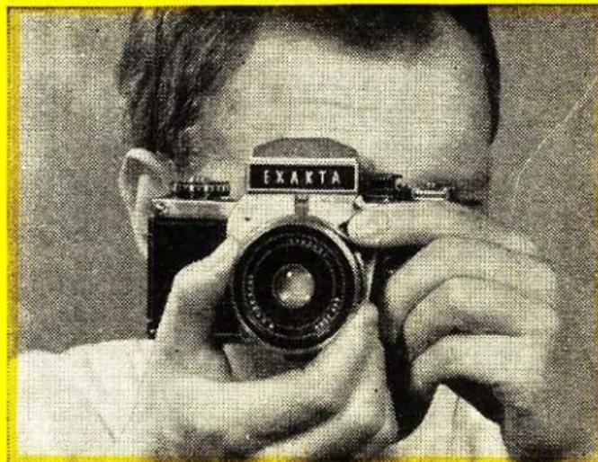
Hand Kamera zusätzlich halten und mit dem linken Zeigefinger auslösen. Für Queraufnahmen auch umgedrehte Kamerahaltung möglich: Als Verwacklungsschutz EXAKTAVX1000 mit der Rückwand gegen die Stirn drücken. Beim Einstellen mit Prismeneinsatz benützen
