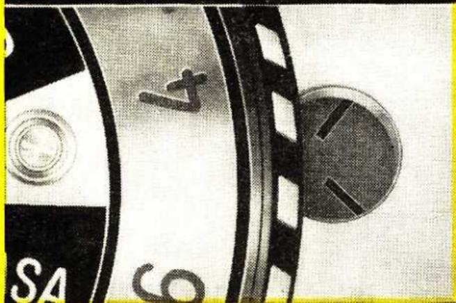
10. Bildzählwerk (6) einstellen. Scheibe des Bildzählwerks (6) mit dem Zeigefinger links drehen (dem Uhrzeiger entgegen), bis beim Gebrauch eines Films für 36 Aufnahmen die Zahl „36“ oder bei einem Film für 20 Aufnahmen die Zahl „20“ in der Mitte des Fensters steht.
