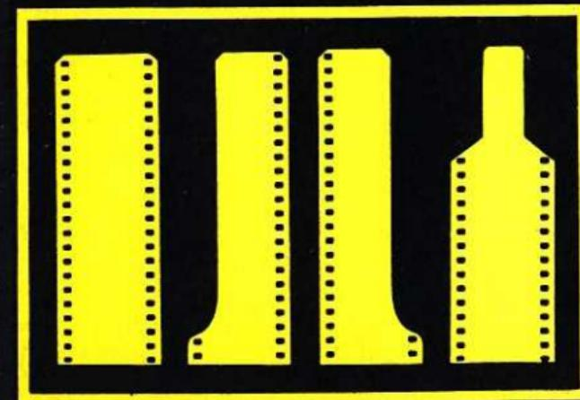
Beim Gebrauch einer Aufwickelspule ist für die EXAKTA VX 1000 kein besonderer Anschnitt des Filmanfangs erforderlich. Jeder Anschnitt ist verwendbar, der handelsübliche mit der schmalen Zunge oder noch besser das nur durchgeschnittene Filmband (z. B. beim Verwenden von Meterware).
