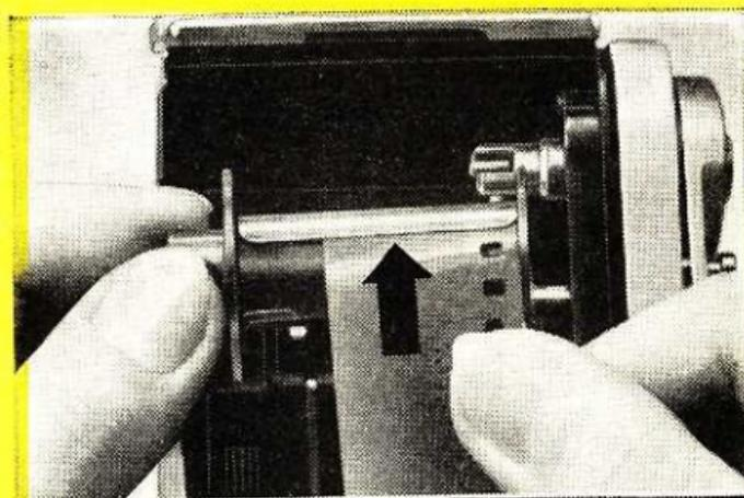
5. Aufwickelspule (32) wieder in die Filmkammer (33) einsetzen und dabei in Aufwickelrichtung leicht drehen, damit der Friktionsmitnehmer (11) des Spannhebels (8) den Steg der Spule faßt und die Spule weit genug in die Filmkammer (33) hineingeschoben werden kann.
