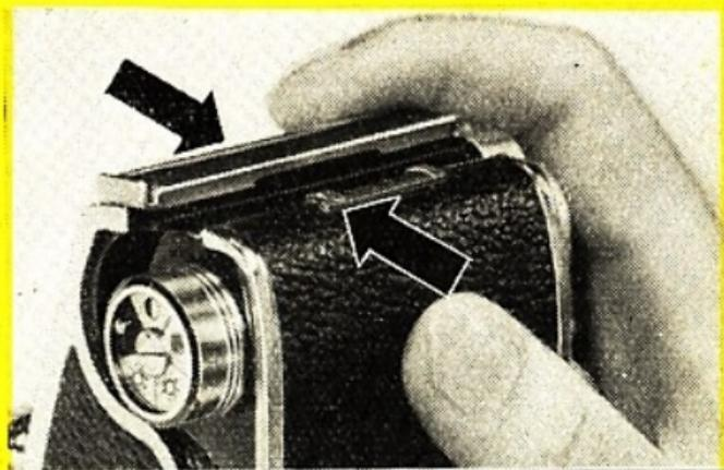
9. Zum Aufspulen des belichteten Filmanfangs zwei Blindaufnahmen machen: auslösen und Spannhebel (8) bis zum Anschlag schwenken. Und nochmals: auslösen und Spannhebel (8) bis zum Anschlag schwenken.
