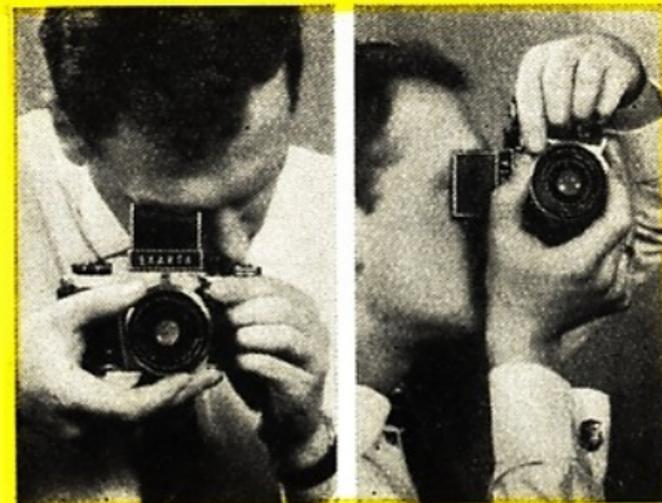
(Mit dem Prismeneinsatz Hochaufnahmen im direkten Durchblick mit seitenrichtigem aufrechtstehendem Sucherbild.) Das Reflexbild im Lichtschacht (13) läßt sich von unten her kontrollieren, wenn man die Kamera über den Kopf hält. So wird man arbeiten, wenn über
