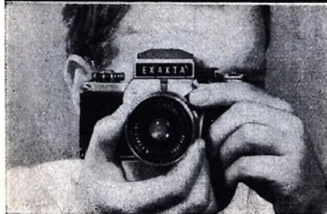
2. Scharfeinstellen durch Drehen am Entfernungseinstellring (25) und durch Kontrollieren der Schärfe des Reflexbildes.
