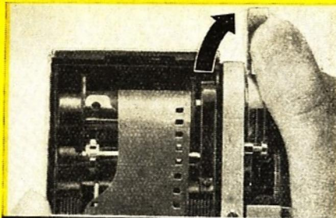
6. Spannhebel (8) bis zum Anschlag schwenken (evtl. vorher den Verschluss auslösen). Nötigenfalls beide Vorgänge wiederholen, bis die Zähne der Filmtransporttrommel (34) auf beiden Seiten in die Filmperforation eingreifen.
