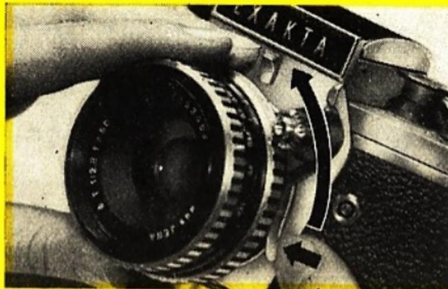
3. Objektiv (28) auswechseln (Objektive aus Jena dafür auf Automatik einstellen): Arretierhebel (30) zum Objektiv hin drücken. Objektiv nach links drehen, bis sich die roten Punkte (23 und 29) gegenüberstehen. Objektiv nach vorn abnehmen. – Beim Einsetzen umgekehrt verfahren: Rote Punkte gegenüberstellen, Objektiv bis zum Einrasten nach rechts drehen. – Spezialobjektive von den kürzesten bis zu den längsten Brennweiten verwendbar.
