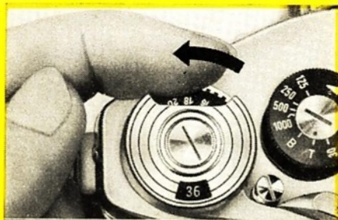
10. Bildzählwerk (6) einstellen. Scheibe des Bildzählwerks (6) mit dem Zeigefinger links drehen (dem Uhrzeiger entgegen), bis beim Gebrauch eines Films für 36 Aufnahmen die Zahl „36“ oder bei einem Film für 20 Aufnahmen die Zahl „20“ in der Mitte des Fensters steht.
