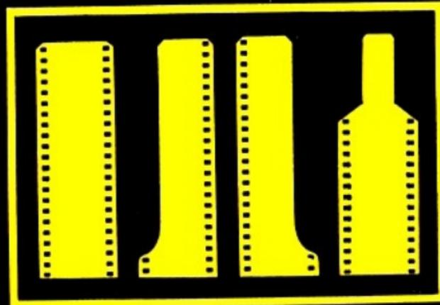
Beim Gebrauch einer Aufwickelspule ist für die EXAKTA VX 1000 kein besonderer Anschchnitt des Filmanfangs erforderlich. Jeder Anschchnitt ist verwendbar, der handelsübliche mit der schmalen Zunge oder noch besser das nur durchgeschnittene Filmband (z. B. beim Verwenden von Meterware).
