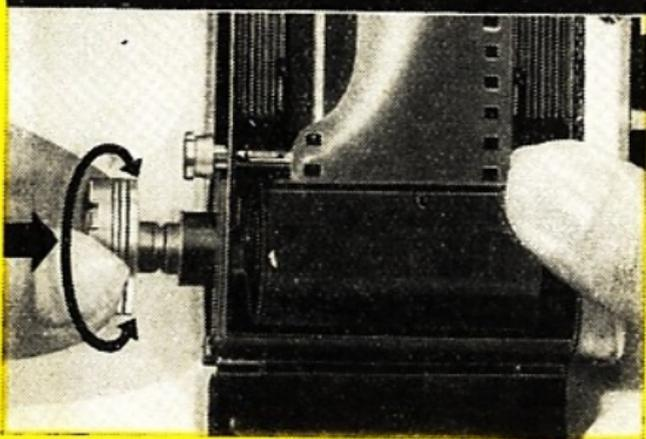
3. Patrone mit unbelichtetem Film in Kammer (41) einsetzen. Knopf der Rückspulkrankel (39) an das Kameragehäuse zurückdrücken und dabei in beliebiger Richtung leicht drehen, damit der Mitnehmer (40) den Steg des Patronenkerns faßt.
