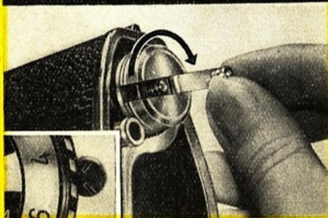
2. Kamera mit der linken Hand fassen. Rückspulkurbel (39) ausschwenken und mit der rechten Hand im Uhrzeigersinn gleichmäßig und nicht zu schnell drehen, bis man spürt, daß sich die Kurbel leichter drehen läßt, der Film also zurückgespult ist. (Beim zu schnellen Drehen können „Verblitzungen“ entstehen, die zu verästelten Negativbelichtungen führen.) Richtiges Rücklaufen des Films ist daran erkennbar, daß sich die Kontrollscheibe (20) mitdreht.
