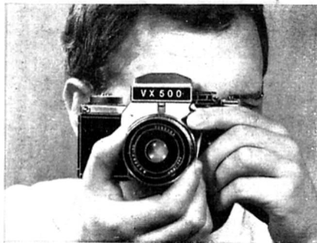
linken oder rechten Auge. Für normale Hoch- und Queraufnahmen VX 500 in die rechte Hand nehmen und mit rechtem Daumen und Zeigefinger scharfeinstellen. Mit der linken Hand Kamera zusätzlich halten und mit dem linken Zeigefinger auslösen. Für Queraufnahmen auch umgedrehte Kamerahaltung möglich: Als Verwacklungs-
