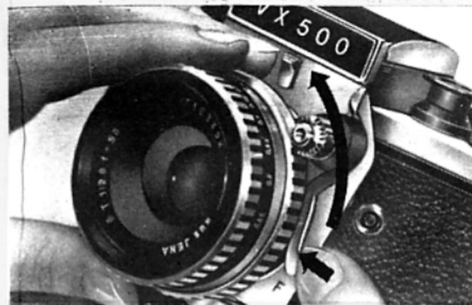
3. Objektiv (26) auswechseln (Objektive aus Jena dafür auf Automatik einstellen): Arretierhebel (28) zum Objektiv hin drücken. Objektiv nach links drehen, bis sich die roten Punkte (21 und 27) gegenüberstehen. Objektiv nach vorn abnehmen. — Beim Einsetzen umgekehrt verfahren: Rote Punkte gegenüberstellen, Objektiv bis zum Einrasten nach rechts drehen. — Spezialobjektive von den kürzesten bis zu den längsten Brennweiten verwendbar.
