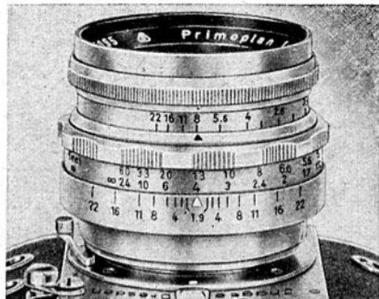
Abb. 14 Kamera aus der Aufnahmehaltung zu nehmen) Rändelring bis zum Anschlag drehen und damit bis zur vorgewählten Öffnung abblenden. Ist der vorderste Rändelring so eingestellt, daß die Blendenzahl 22 am roten Punkt steht, dann ist bei den größeren Blendenöffnungen kein Anschlag vorhanden.
