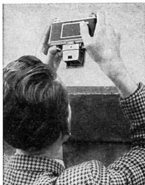
der Prismeneinsatz oder der Belichtungsmesser-Einsatz verwendet wird), scheidet aber bei Photos auf kürzeren Abstand als etwa 3 m der Parallaxe wegen aus. Ebenso ist bei Weitwinkel- und Teleobjektiven die Benutzung des Rahmensuchers nicht zu empfehlen, da der Sucherausschnitt nur für die Normalobjektive Gültigkeit hat.
