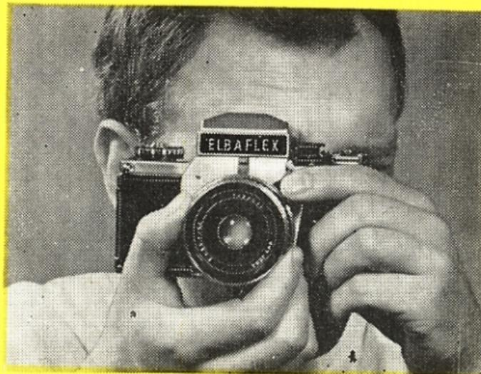
Hand Kamera zusätzlich halten und mit dem linken Zeigefinger auslösen. Für Queraufnahmen auch umgedrehte Kamerahaltung möglich: Als Verwacklungsschutz ELBAFLEX 1000 mit der Rückwand gegen die Stirn drücken. Beim Einstellen mit Prismeneinsatz benützen
