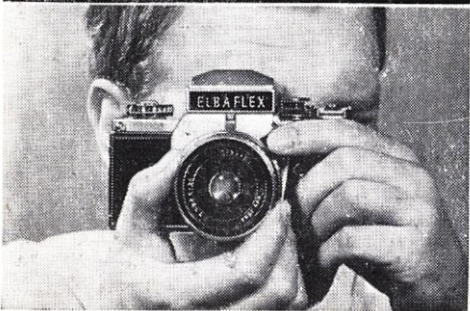
Zum Scharfeinstellen nach dem Reflexbild große Objektivöffnung, also kleinste Blendenzahl, anwenden (helles Bild), und erst kurz vor dem Belichten abblenden. Nicht erforderlich ist, dafür die Kamera aus der Aufnahmehaltung abzusetzen, weil die Objektiv mit vollautomatischer Druck- oder Springblende versehen sind. Näheres siehe Objektivbeschreibungen ab Seite 26.
