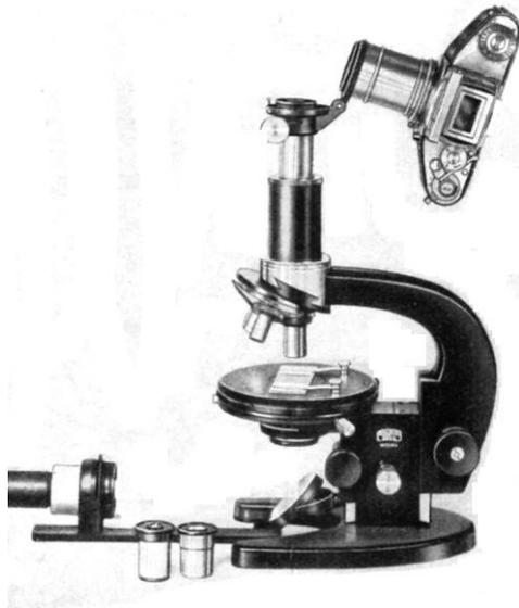
исполнении № 2 отличается от исполнения № 1 тем, что нижняя и верхняя часть тубуса разъединяются совершенно, в то время как в исп. № 1 они соединены шарнирно.
