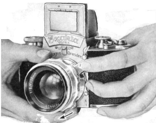
Согласно с рис. 16 следует завести автоматически диафрагм: рычаг под объективом повернуть вправо, смотря в направлении снимаемого объекта. При полном относительном отверстии объектива заводной механизм защелкивается, а рычаг самостоятельно возвращается в исходное положение. Заводка механизма может быть осуществлена,
