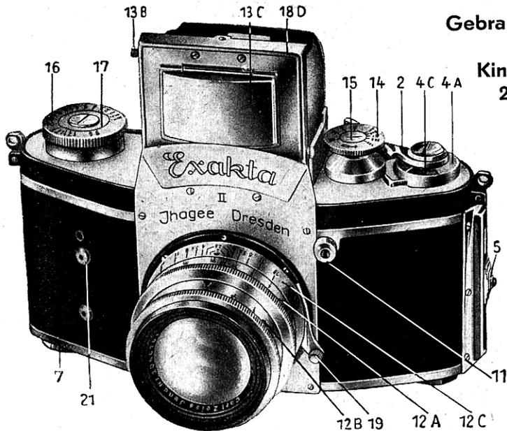
Achtung! Bei jeder Bedienung des Apparates ist grundsätzlich als erstes der Lichtschacht zu öffnen, als zweites der Filmaufzugshebel (2) bis zum Anschlag zu betätigen. Bei Benutzung des Vorlaufwerkes (16) ist dieses stets erst aufzuziehen und danach erst einzustellen
