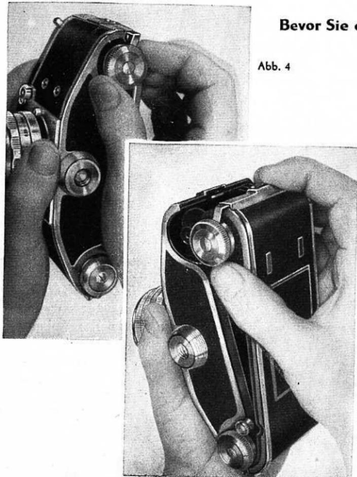
machen Sie sich bitte erst mit der ungeladenen Kamera vertraut. Üben Sie die Verschlussbedienung, das Öffnen und Schließen der Kamera, das Suchen des Motivs und das Scharfeinstellen sowohl mit dem Lichtschacht als auch mit dem Prismeneinsatz. Handhaben Sie die Kamera dabei so, als wäre sie mit einem Film geladen. Erst ganz zum Schluß kommt das Filmeinlegen an die Reihe. Auch dabei ist es günstig, wenn Sie zunächst mit einem alten, vielleicht schon belichteten Film probieren.
