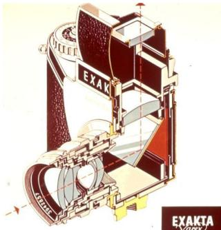
3. Wie jede einäugige Spiegelreflex ist auch die EXAKTA Varex mit einem beweglichen Spiegel versehen, der das vom Objektiv entworfene Bild an die horizontal gelagerte Mattscheibe reflektiert. Demzufolge stimmen Reflexbild und Aufnahme parallaxenlos überein. Das Reflexbild im Lichtschachteinsatz der EXAKTA Varex wird von zwei Einstelllupen insgesamt 6fach vergrößert, so daß sich in jedem Fall mühelos die höchste Schärfe einstellen läßt.
