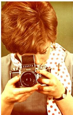
5. Für das Einstellen mit beiden Lupen nimmt man die EXAKTA Varex dicht ans Auge. Der Lichtschachteinsatz eignet sich für den Großteil aller Motive, vor allem unter Augenhöhe und ohne stärkere Bewegung, doch wird dieses Einstellsystem auch für technische Arbeiten im Heim und Atelier, namentlich mit Stativ, oder anderer Kamerafixierung, bevorzugt, z. B. für Reproduktionen, Stilleben, Mikroaufnahmen usw.
