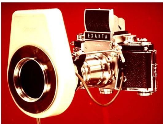
45. Die Ihagee-Ringblitzleuchte RB 2 ist auf diesem letztgenannten Sondergebiet nicht verwendbar, sondern wurde für den allgemeinen Arbeitsbereich der Nahblitztechnik bewußt einfacher gehalten. Der Ringdurchmesser der Blitzröhre ist größer, so daß man die Ringblitzleuchte RB 2 in Verbindung mit dem Normalobjektiv 50 mm und mit Spezialobjektiven 80 mm Brennweite benutzen kann. Die prinzipiellen Vorteile sind die gleichen wie bei dem Typ RB 1.
