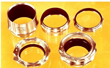
26. Nicht alle photographischen Aufgaben aber lassen sich durch die Wahl eines geeigneten Spezialobjektivs lösen. Nahaufnahmen auf kürzesten Abstand erfordern z. B., daß man den Abstand zwischen Objektiv und Kameragehäuse verlängert. Das kann bei der EXAKTA Varex in sehr einfacher Weise schon durch Bajonettringe und Tuben geschehen. Man setzt sie beliebig kombiniert zwischen Objektiv und Kamera ein, so daß sich alle gewünschten Abbildungsmaßstäbe
