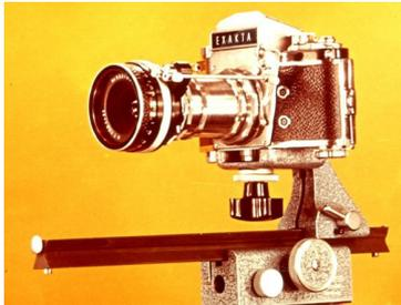
28. Für das bequeme Einstellen bei Nahaufnahmen mit Bajonettringen und Tuben empfiehlt sich das Schwenkwinkelgerät. Es läßt sich waagrecht und senkrecht an einem Stativ anbringen, und mit dem Zahntrieb des Einstellschlittens wird auf höchste Schärfe eingestellt. Die Kamera kann schnell von quer auf hoch und umgekehrt geschwenkt werden. Das Schwenkwinkelgerät gehört zum Ihagee-Vielzweckgerät, das wir Ihnen noch näher vorstellen werden. Seine Teile sind allein oder miteinander
