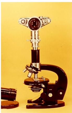
Lichtschutzmanschetten greifen ohne Berührung ineinander und verhüten das Einwirken von Fremdlicht. Mit dem Balgenauszug kann der Abbildungsmaßstab der Mikroaufnahme verändert werden.
