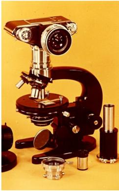
37. Extreme Nahaufnahmen bis etwa zum Abbildungsmaßstab 10,0 werden häufig auch unter Zuhilfenahme eines Mikroskops angefertigt, das hierbei ohne Okular und Tubus nur mit einem geeigneten Objektiv arbeitet. Für diese Zwecke sind besonders die Objektive Jena „M“ bestimmt. Das Oberteil des Mikrozwischenstückes läßt sich bei diesen Nahaufnahmen, wie die Abbildung zeigt, direkt an den Tubusträger der modernen L- und N-Stativ aus Jena ansetzen.
