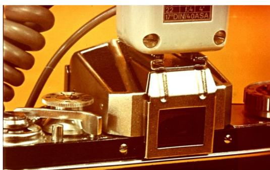
13. Der Steckschuh, der am Sucherfenster des Prismeneinsatzes befestigt wird, ermöglicht es, Zubehör unmittelbar an die Kamera anzusetzen, z. B. ein Blitzgerät oder einen Belichtungsmesser.
