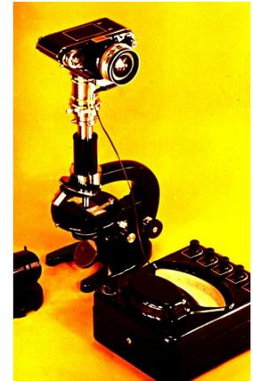
39. Hier befindet sich das Selen-Sperrschichtelement der Lichtmeßeinrichtung in Meßstellung. Der Auslöseknopf der Kamera wird dabei zum Verhüten ungewollter Betätigung verdeckt. Die Auswertung der Meßergebnisse setzt die Anfertigung einer Serie von Probeaufnahmen mit abgestuften Belichtungszeiten voraus. Danach können in Zukunft die Daten der richtig belichteten Aufnahme jederzeit wieder angewendet werden.
