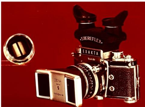
selbstverständlich auch dem dreidimensionalen Photo den gebührenden Platz eingeräumt, und mit Hilfe der an das Normalobjektiv anschraubbaren Stereovorsätze können mit der EXAKTA Varex auch Raumbildaufnahmen hergestellt werden. Der große Stereovorsatz ist für Aufnahmeentfernungen von Unendlich bis 2 m bestimmt, der kleine Stereovorsatz, der links neben der Kamera zu sehen ist, kann für Aufnahmeentfernungen von 2 m bis 0,15 m benützt werden. Damit man die Wirkung der
