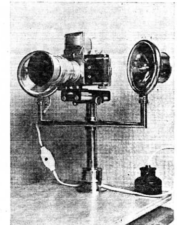
Fig. 4. De foto-installatie, thans aangevuld met Novoflex-instelslede voor accurate en snelle fijninstelling
