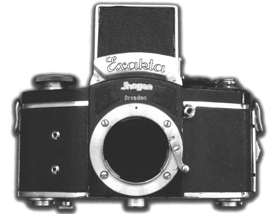
Eine Replika des Prototypen der Kine-Exakta, so wie er auf der Leipziger Frühjahrsmesse vorgestellt wurde. Die Lupe fehlt, die Lichtschachtabdeckung erinnert stark an die VP Exakta. Die Kopie des Prototypen wurde von dem verstorbenen amerikanischen Sammler Jim Hayes auf Basis zeitgenössischer Abbildungen angefertigt.
